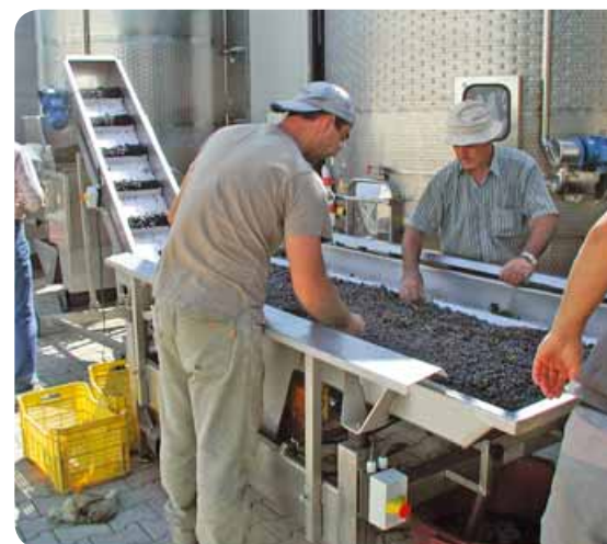
Foto 3 - Utilizzo del tavolo di cernita e diraspatrice per l'eliminazione dei materiali estranei e dei raspi residui. Si noti sotto il tavolo di cernita la possibilità di eliminare anche il poco mosto ottenuto per il leggero schiacciamento degli acini
